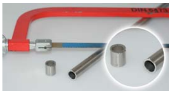
Résultat de coupe avec une scie à métaux (Crête extérieure et intérieure)
